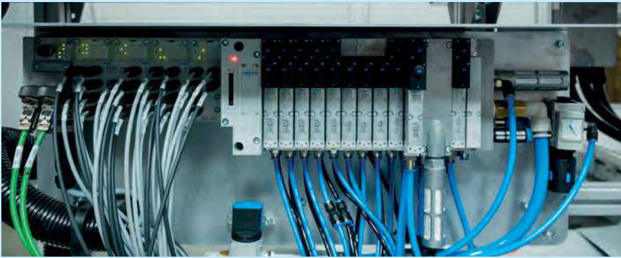
Remote IO ventielterminal CPX-VTSA aangestuurd door Profinet
