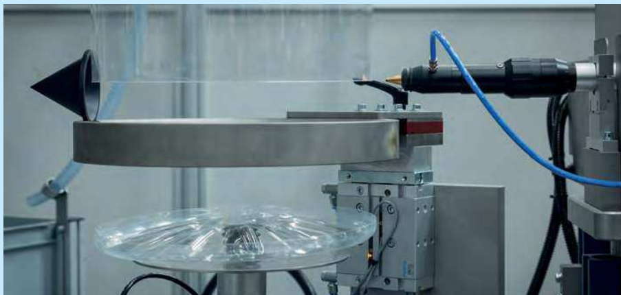
De onderkant van het fust wordt met een laser opengesneden.
